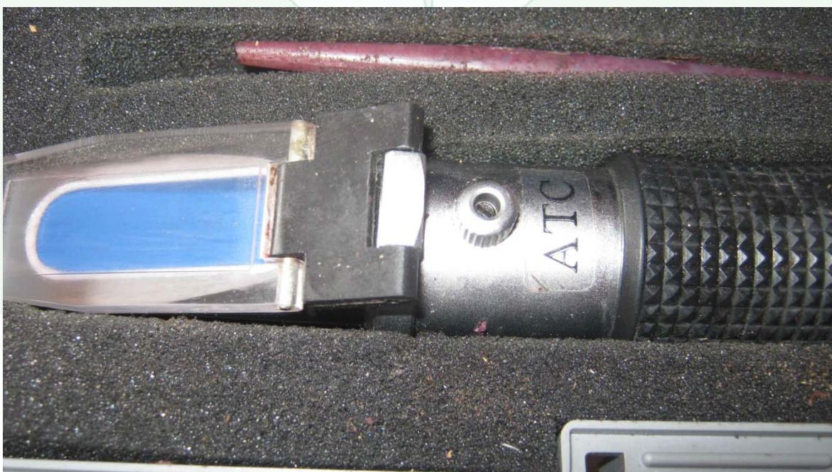
Refraktometar je najčešće korišćen optički instrument za određivanje šećera u širi. Lak je za rukovanje i rad na terenu. Preciznost je zadovoljavajuća.
